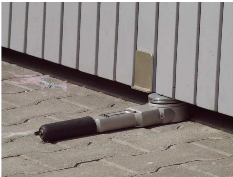
Foto 4: Bij garagedeuren is het essentieel dat de toegestane werkkrachten van maximaal 400 newton (ca. 40 kilo) worden nageleefd bij het raken van een hindernis, en dat de garagedeur binnen 750 milliseconden automatisch terugkeert, dus naar boven terugloopt. Gespecialiseerde bedrijven kunnen met zogenoemde sluitkrachtmeters controleren of dat het geval is.
